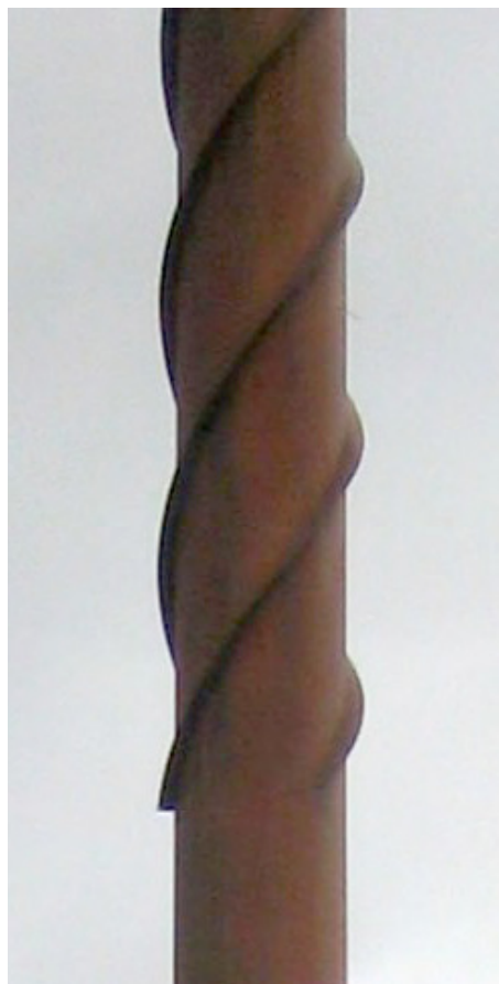
Det spiralformade bandet på höga skorstenar hindrar att kraftig vind sätter skorstenen i svängning.
