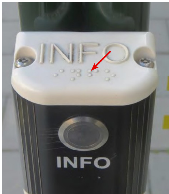
Genom att trycka på knappen kan resenärerna få talad trafikinformation. Vid knappen finns också punktskrift (blindskrift) - se pilen.
